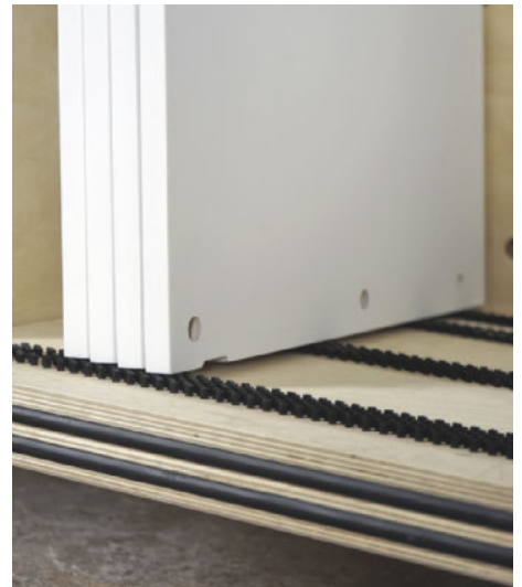
/ Durchdachte Details wie die Bürsten zum Kanten-schutz zeichnen den Kommissionierwagen aus.
